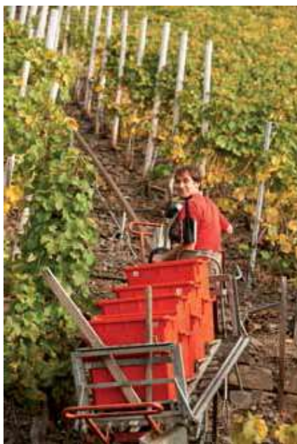
Mit Monorackbahnen werden Material oder Trauben in den Steillagen transportiert
